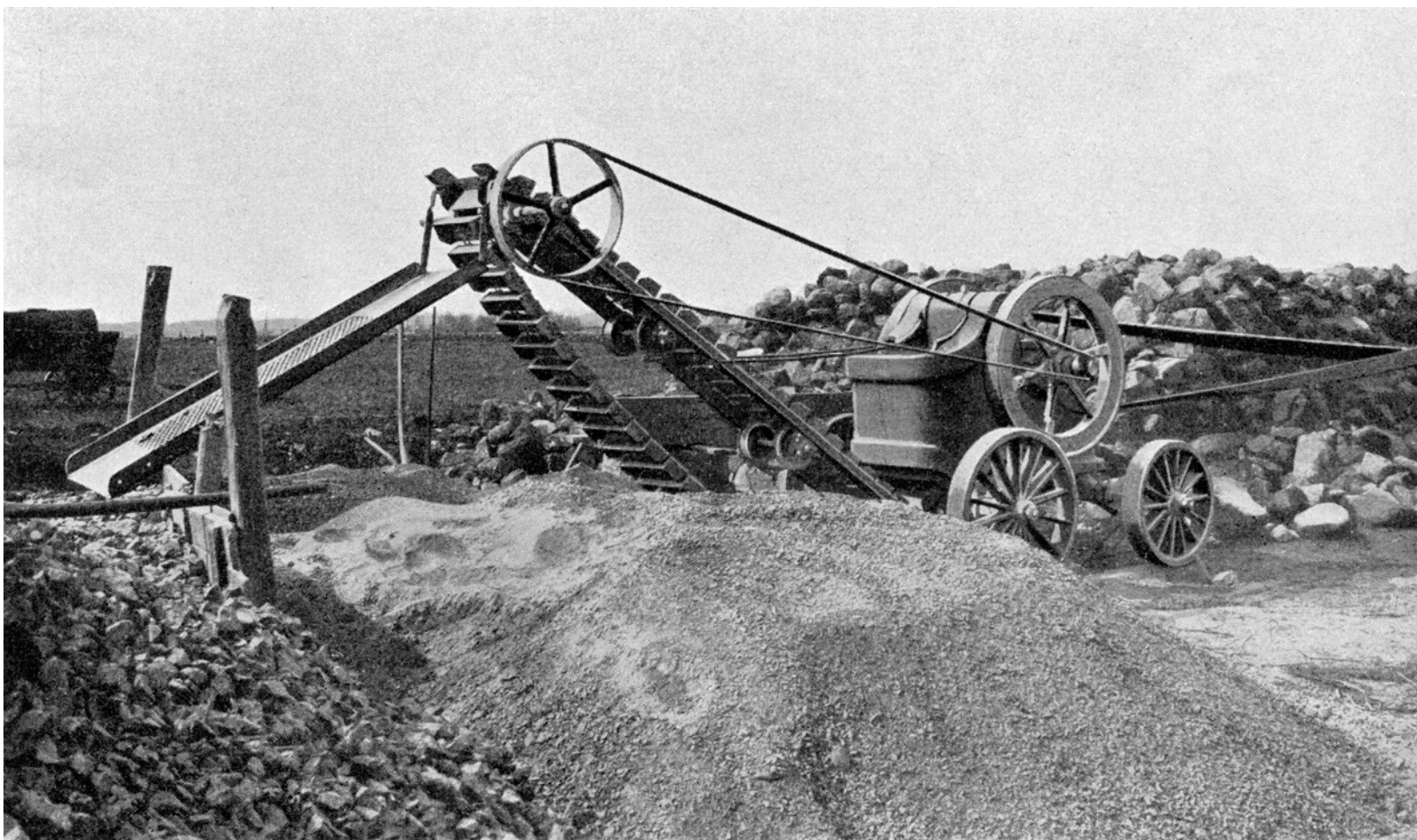
Stenkross, med elevator och såll, tillverkad vid Åbjörn Anderssons mekaniska verkstad under tidigt 1900-tal.
