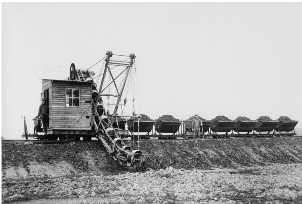
Lerupptagningsmaskin vid Böringe tegelbruk. Bruket, som startades 1884 av C.A. Beck-Friis, upphörde 1964. Maskinen var sannolikt tillverkad vid Åbjörn Anderssons mekaniska verkstad.
