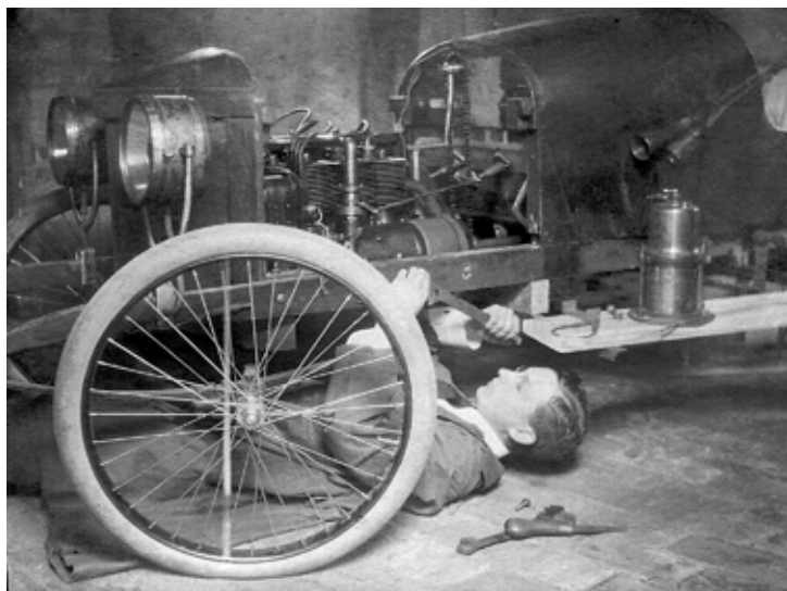
Per Weiertz liggande under Self 1 i garaget 1918. Lägg märke till ramen i askplank, den nymonterade luftkylda Phänomenmotorn och belysningsens acetylenaggregat på fotbrädan.
