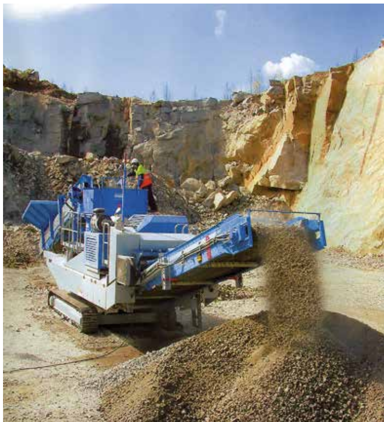
Ett lätttransporterat kross- och sorteringsverk under arbete i ett stenbrott. Ett typiskt exempel på alla "allt-i-ett-maskiner" från Svedala.
