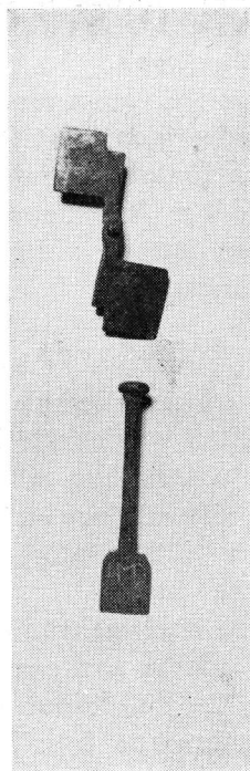
Fig. 54. Knapphålsjärn för olika storlekar. Märkt H. M. D.
